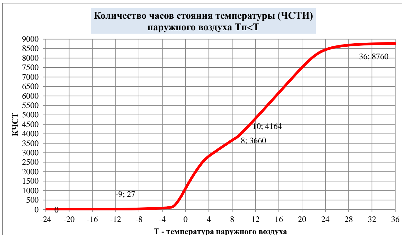
Рисунок 2 – Количество часов стояния температуры наружного воздуха T_n со значением меньше T
