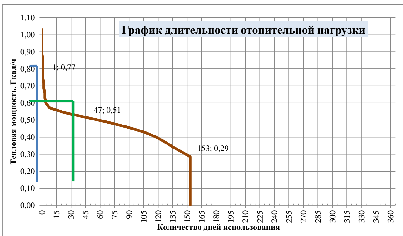
Рисунок 3 – График длительности отопительной нагрузки в МО Раздольненский район
